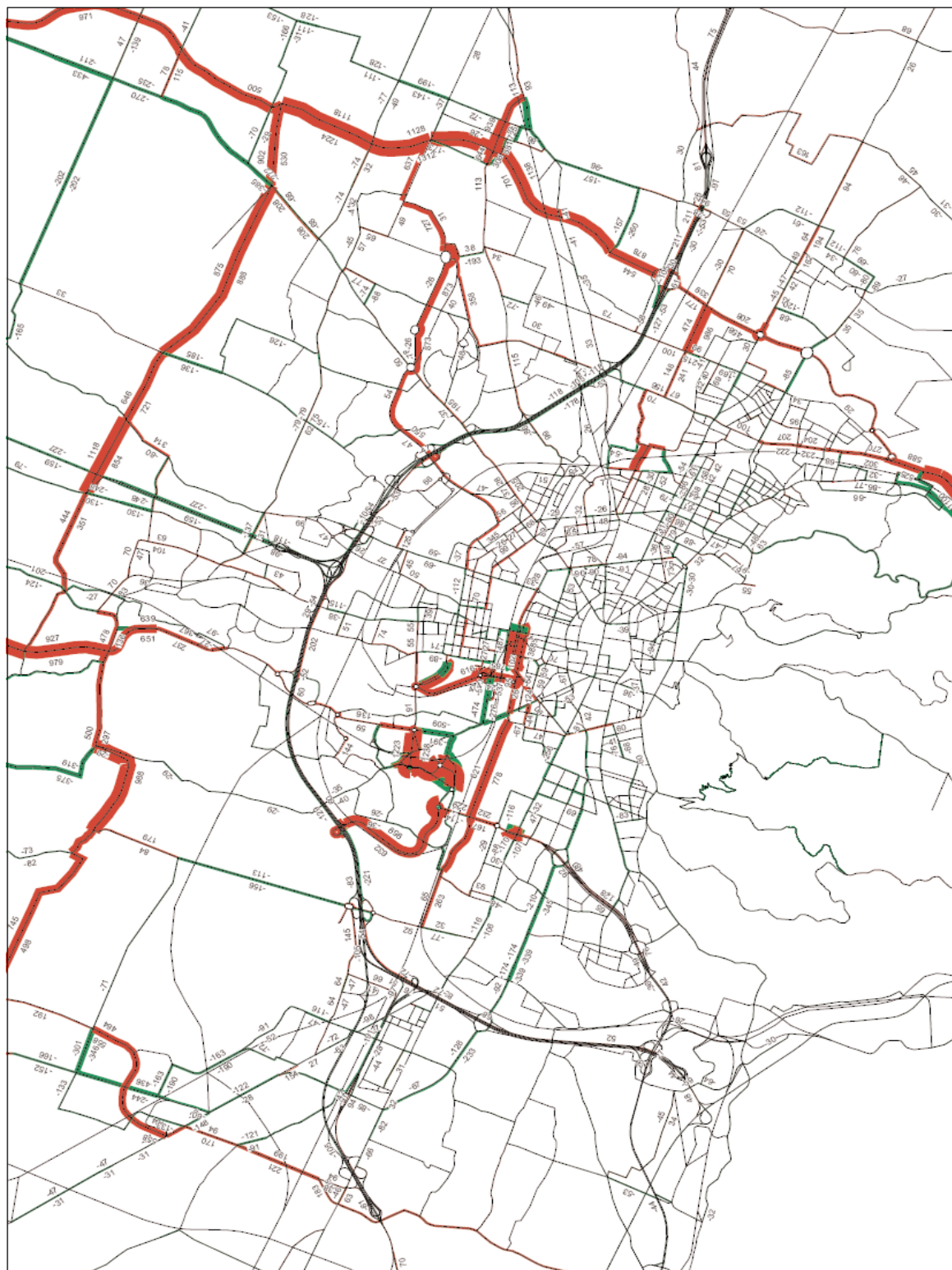
Rete di differenza tra scenario attuale e scenario di progetto (ipotesi di minima) con mitigazioni da Pgtu (in rosso, gli incrementi e in verde le diminuzioni dei flussi rispetto alla situazione attuale)
