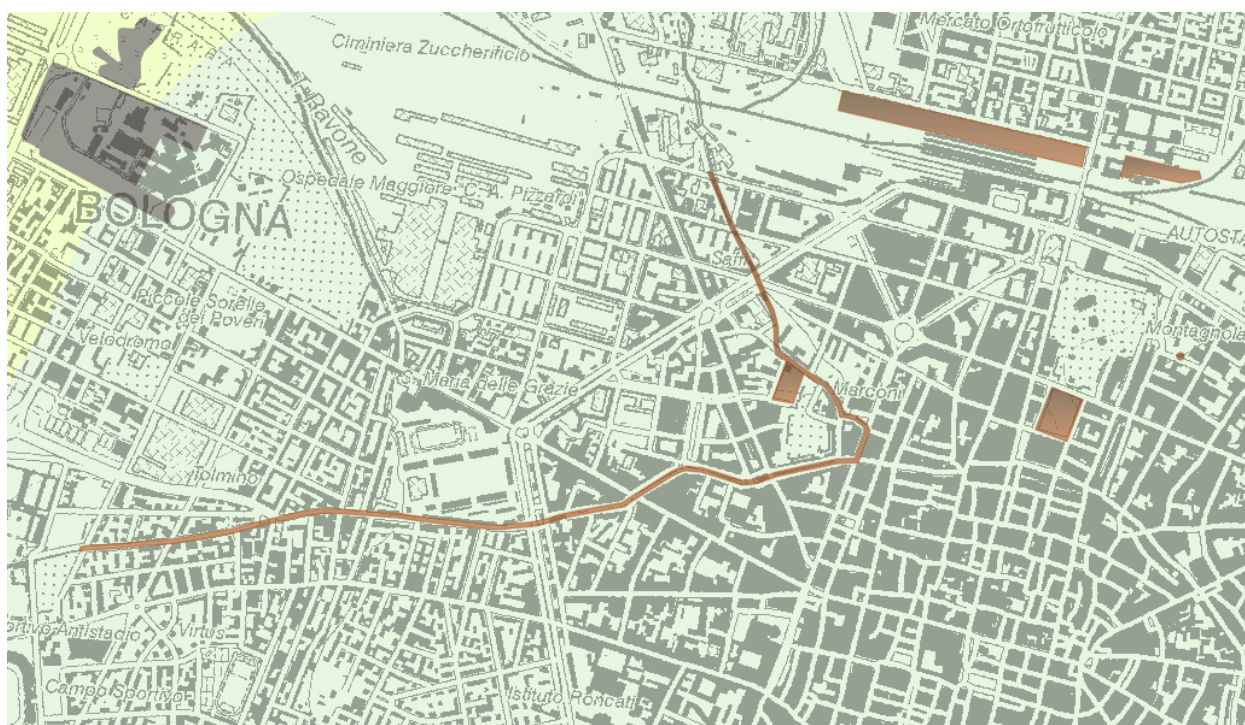
Figura 3.13– Delimitazione di alcune delle “aree con cavità sepolte” antropiche presenti nel territorio urbano del Capoluogo (canali Reno e Cavaticcio; Alta Velocità; parcheggi interrati) e riportate nella cartografia MOPS
